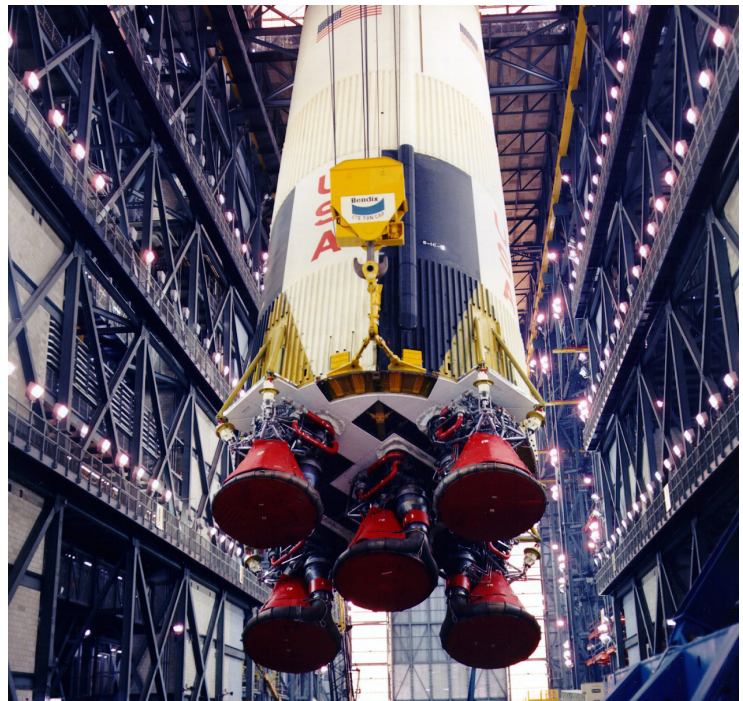
Oben: Wernher von Braun vor „seiner“ Saturn V. Zu sehen sind vier der fünf gewaltigen F-1 Triebwerke der ersten Stufe. Die scheinbar ringförmigen Strukturen an der Außenseite des oberen, schmalen Bereichs der Düsen (im Bild gerade noch zu sehen) sind Treibstoffleitungen, die um die Brennkammer gewickelt sind. Damit wird diese gekühlt, um der Hitze standhalten zu können. Gleichzeitig wird der Treibstoff vorgewärmt. Alle Bilder dieser und der nächsten Seite: NASA
